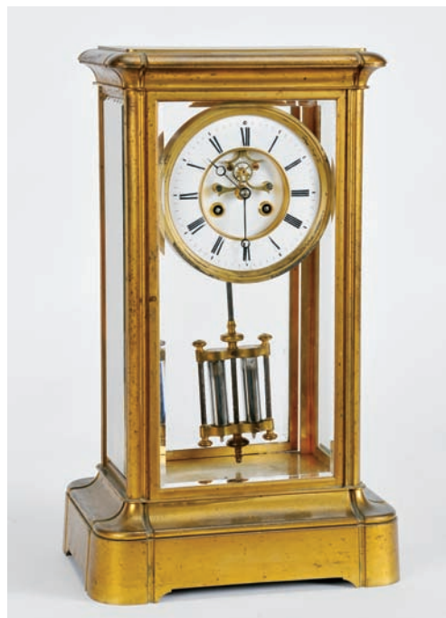
816 RELÓGIO DE MESA , caixa em bronze dourado, faces em vidro bizelado, mostrador em esmalte, escape "Brocot" sem recuo, pêndulo de mercúrio, autonomia de oito dias, toca horas e meias horas, regulação da marcha no mostrador, francês, séc. XIX/XX, pequenos defeitos, mecanismo a necessitar de revisão Dim. - 47 x 27,5 x 21 cm
