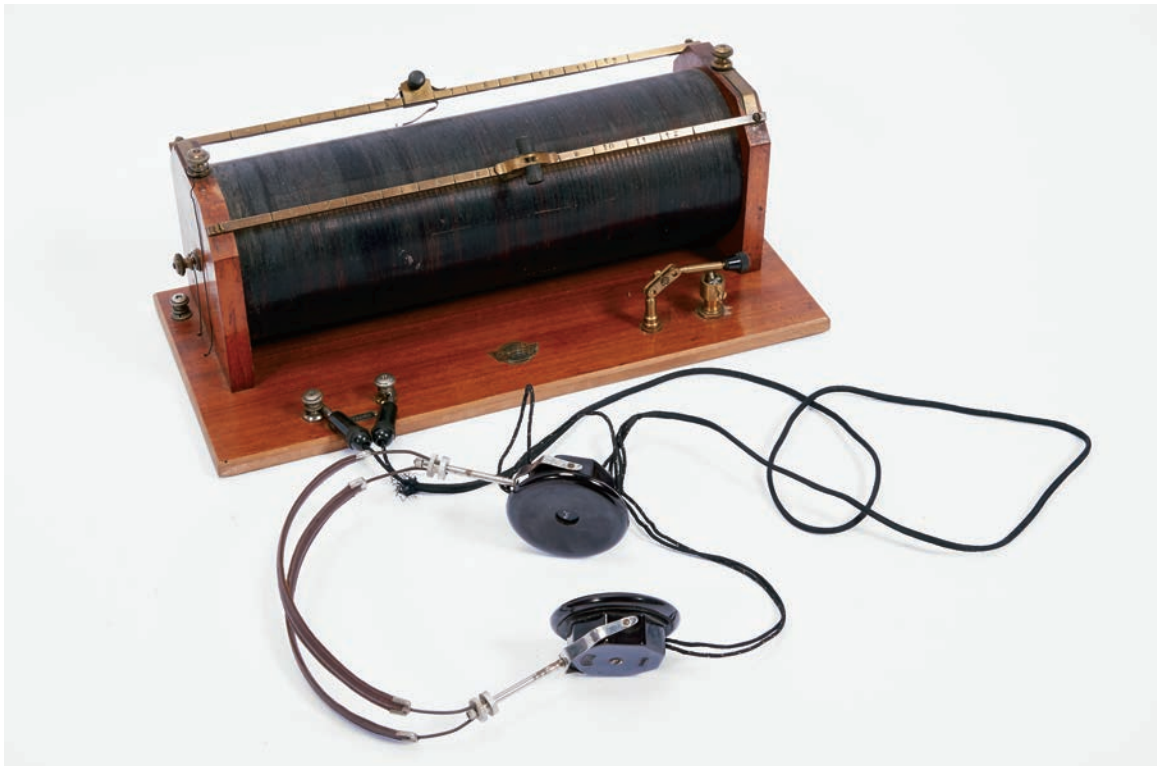
1054 RÁDIO DE GALENA DERVY , estrutura de madeira com metal amarelo, fio de cobre, auscultadores de metal, baquelite e pele, francês, séc. XIX (finais), sinais de uso, marcado Dim. - 14 x 37 x 17 cm
